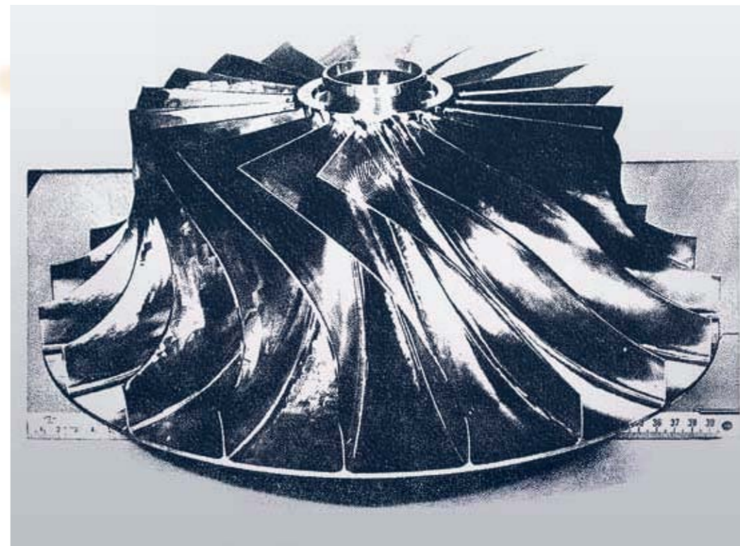
„Rad 0“, das erste in FVV-Projekten eingesetzte Verdichterlaufrad
