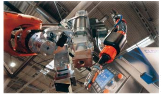
Innovatives Messe-Exponat: Laser-Lichtbogen-Hybridschweißgerät
