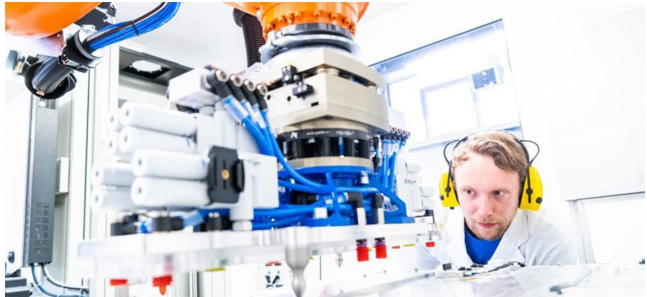
Roboterassistierte Brennstoffzellen-Stack-Montage am ZSW in Ulm.
