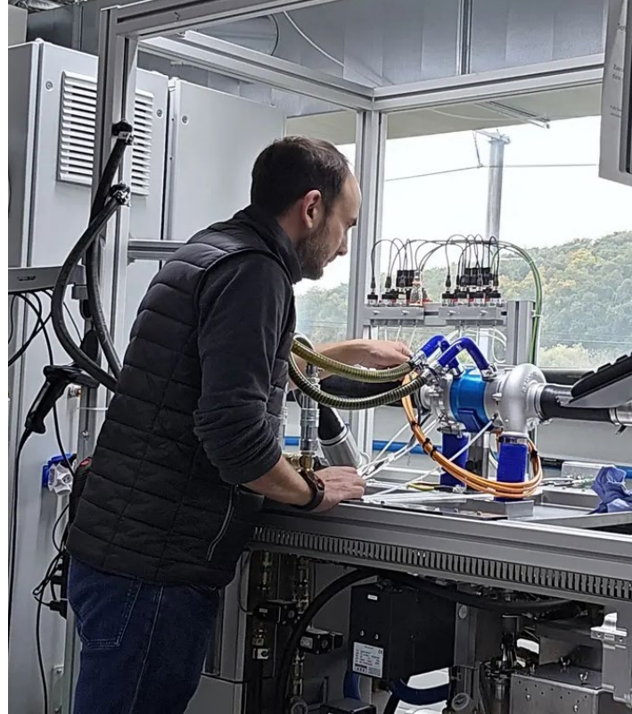
Präzisionsarbeit am Prüfstand: Verdichter als Schlüsselkomponente der Brennstoffzelle für effiziente und leistungsfähige Systeme.
