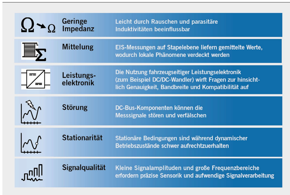
BILD 2 Herausforderungen der integrierten EIS-Messung © [M] Adobe | Ohm
