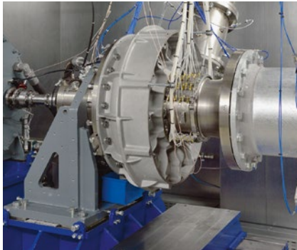
Der neue FVV-Prüfstand am IST ist eine der leistungsfähigsten Radialverdichter-Forschungsanlagen in Europa
