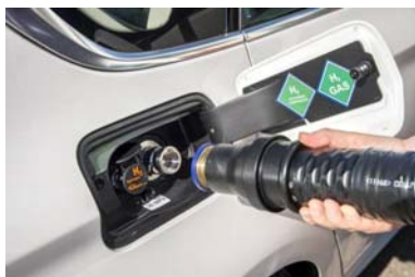
3 | Betankung des Wasserstoffspeichers © BMW Group | P90189152
