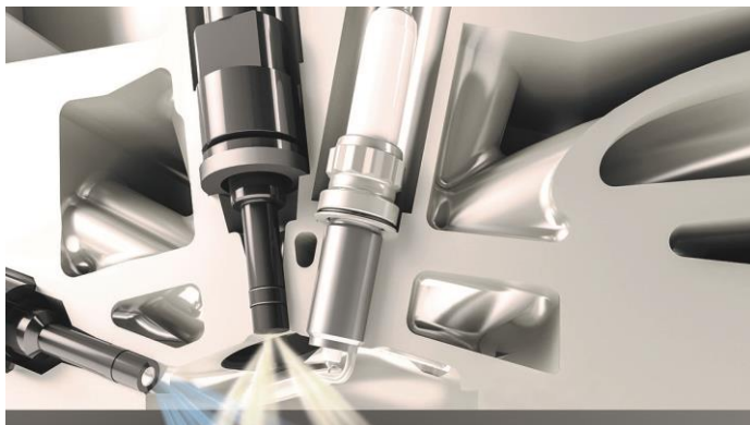
2 | Wasser-Zusatzeinspritzung mobilisiert mehr Leistung und senkt den Verbrauch © vka | RWTH Aachen
