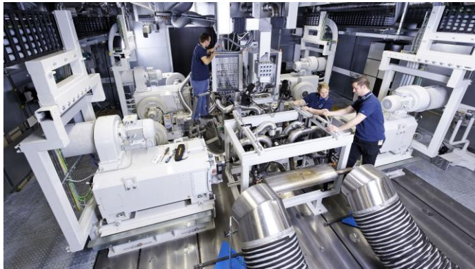
1 | Motorprüfstand zur Erforschung des elektrifizierten Antriebsstrangs am Center for Mobile Propulsion (CMP) © Peter Winandy | RWTH Aachen
